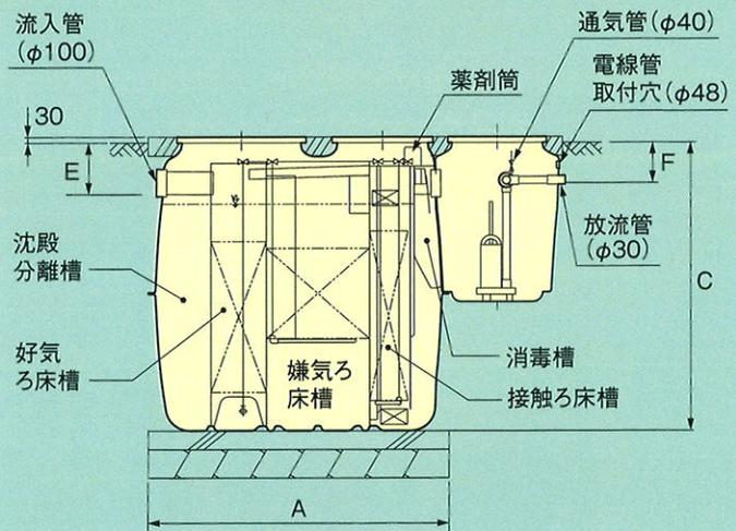
※1 本体寸法の高さC、流入管底、放流管底は、マンホール天端からのサイズはプラス30mmになります。
